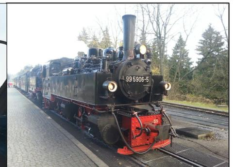
Der eigens für unsere Sonderfahrt angemietete Brockenzug bestand diesmal aus zwei Dampfloks. Die vordere Lok war 99 5906, eine Malletlokomotive aus dem Jahr 1918, die zweite war die 1939 gebaute Einheitslok 99 6001. Diese beiden Loks brachten den Zug in gemütlicher Fahrt zum 1125 Meter über dem Meeresspiegel gelegenen Brocken Bahnhof. Bei den planmäßigen Zugkreuzungen und dem Wassereassen boten sich sehr gute Motive um diesen besonderen Zug zu fotografieren.
